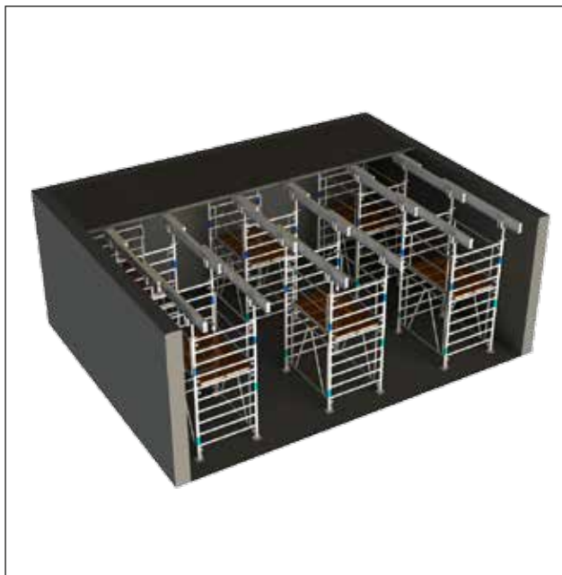
- Étalement de dalles alvéolaires avec AL200 sur tours A120.
