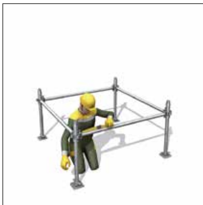
- Implantation et mise à niveau.
